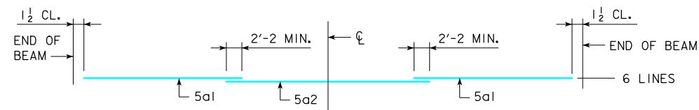
TOP FLANGE LONGITUDINAL BAR LAYOUT
